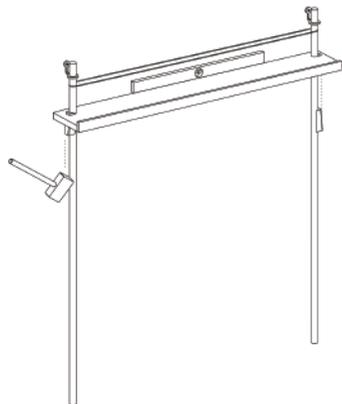
棚板を脚に沿わせて下から引き上げます。水平器を使い、棚板が水平になるようにします。棚の位置が決まったら、クサビを下から穴に差し入れ、ハンマーでたたきながら棚板を固定します。
