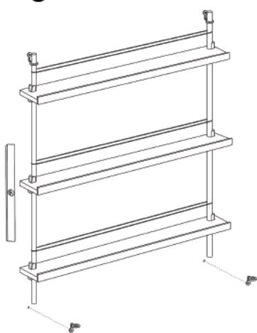
棚板が全て取り付け完了したら、脚が垂直になるように微調整し、下部のウォールブラケット用の下穴の位置に印をつけ、下穴をあけます。
