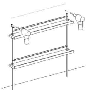
組み立てた下部のセクションを壁に立てかけ、2つのウォールブラケット用(上部)の下穴をあけるための印をつけ、穴をあけます。これらの穴は766mmの間隔で水平にあけてください。壁の材質により、必要であれば適切なアンカーを使用してください。
