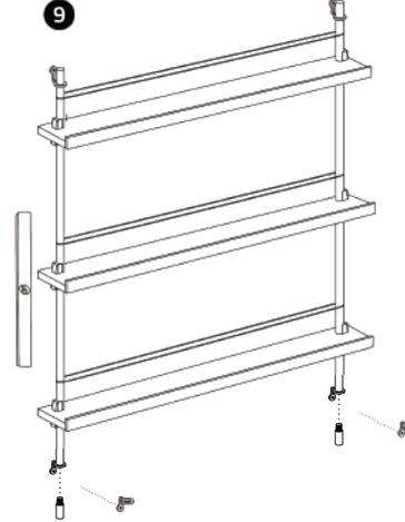
エンドボルトをウォールブラケットを挟み込むように下側からねじ込み固定します。
