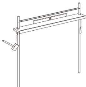
棚板を脚に沿わせて下から引き上げます。水平器を使い、棚板が水平になるようにします。棚の位置が決まったら、クサビを下か穴に差し入れ、ハンマーでたたきながら棚板を固定します。
