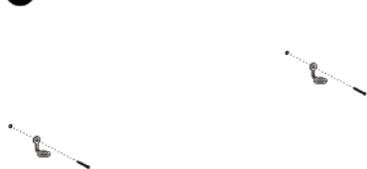
下穴に、上部のウォールブラケットを付属のネジで固定します。
