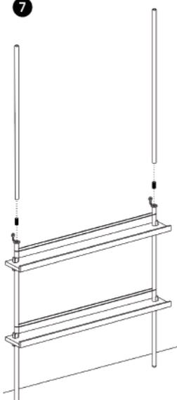
下部セクションの脚の先端にコネクタを回し入れます。奥までしっかりねじ込んでください。その後、追加の脚をコネクタにねじ込みます。
