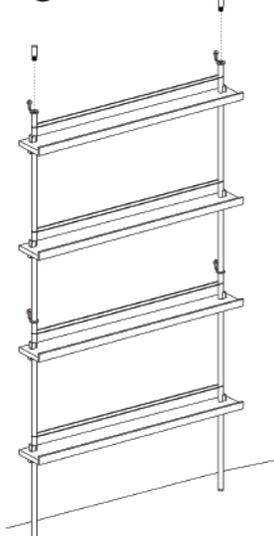
ウォールブラケットをビスで留めた後、エンドボルトをウォールブラケットを挟み込むように下側からねじ込み固定します。
