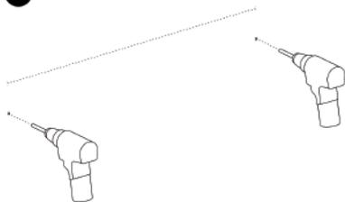
2つのウォールブラケット用(上部)の下穴をあけるための印をつけ、穴をあけます。これらの穴は766mmの間隔で水平にあけてください。壁の材質により、必要であれば適切なアンカーを使用してください。
