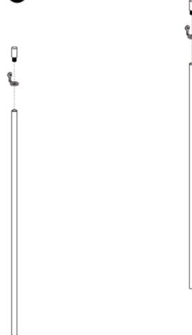
2本の脚をウォールブラケットを挟むようにエンドボルトで上からねじ込んで固定します。
